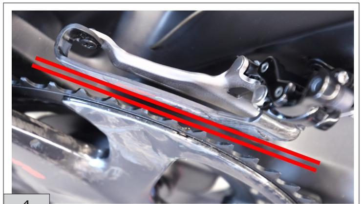
5) Den Umwerfer in Position halten und die Schraube der Befestigung mit dem vorgeschriebenen Anzugsmoment festziehen: **7 Nm (62 in.lbs)** (Abb. 5).
