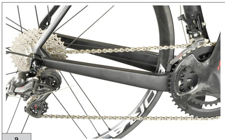
**10)** Drehen Sie an der äußeren Anschlagschraube (Abb. 10), so dass sich das äußere Leitblech in einem Abstand von 0,5 mm von der Kette befindet (Abb. 10).
