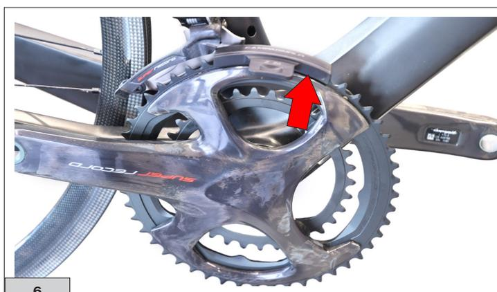
7) Das Kettenrad gegen den Uhrzeigersinn drehen, bis sich das Werkzeug unter der Gabel des Umwerfers befindet.
