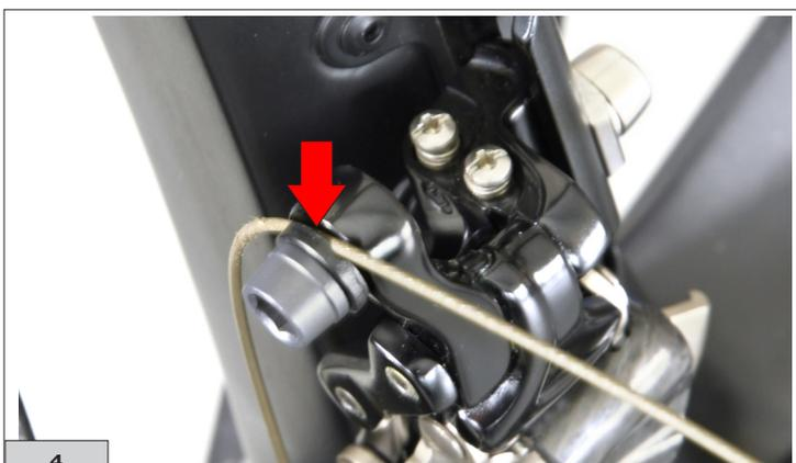
**5)** Prüfen Sie, ob sich der auf der Spannscheibe des Schaltzugs befindliche Zahn in der Ausnehmung auf dem Pleuel des Umwerfers (Innenseite) positioniert (Abb. 5).
