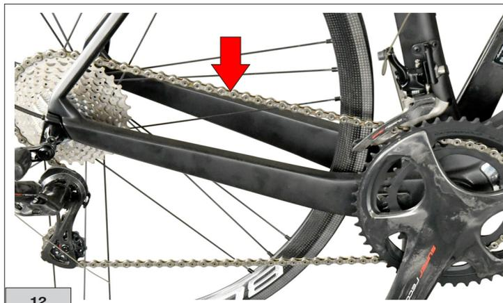
13) Die Schraube für den inneren Endanschlag einstellen, sodass sich die innere Gabelhälfte in einem Abstand von 0,5 mm zur Kette befindet (Abb. 13).
