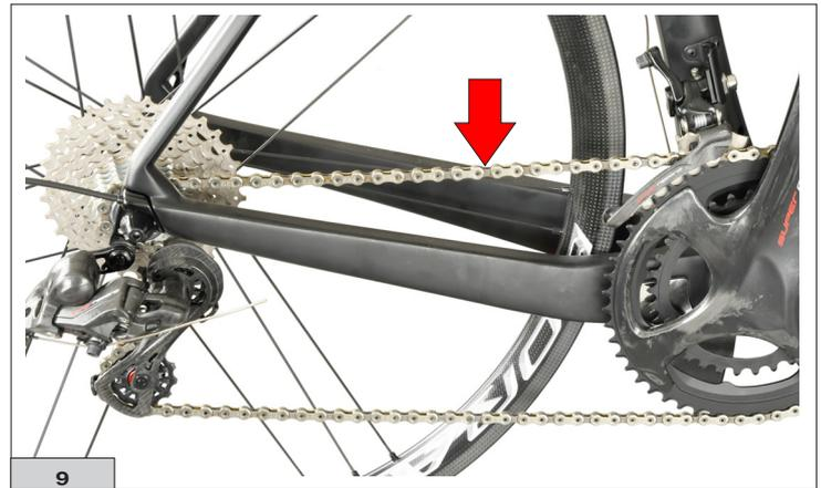
**10)** Die Schraube für den äußeren Endanschlag des Umwerfers einstellen: Der Abstand zwischen äußerer Gabelhälfte und Kette muss circa 0,5 mm betragen (Abb. 10).
